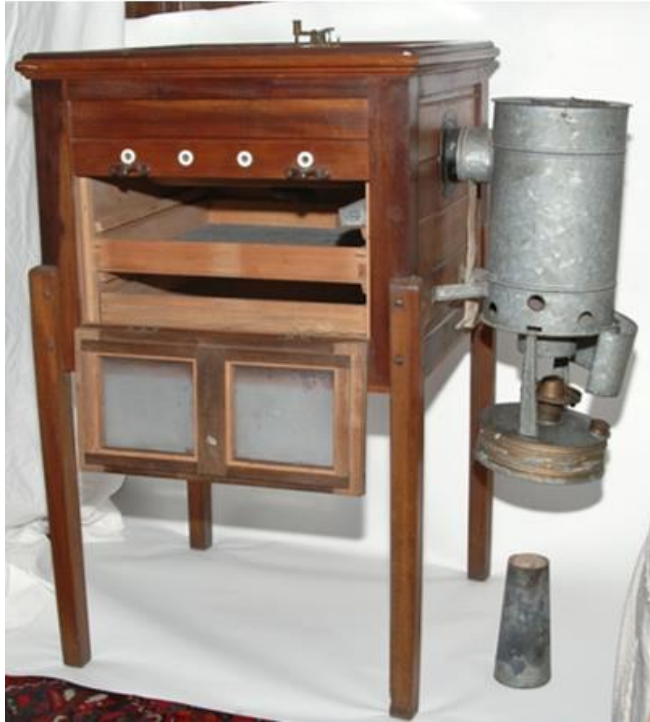
Figura 6: Chocadeira movida a querosene. O calor produzido pelo fogareiro localizado na base do cilindro metálico era enviado ao interior da máquina por uma conexão entre ambos. Acervo do Museu Paulista-USP.
