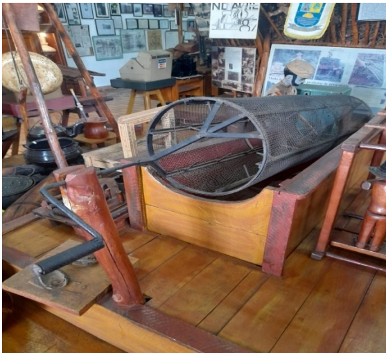
Figura 25: Réplica de tambora para sapeco. Fonte: LEAL, G. Q., 2022.
