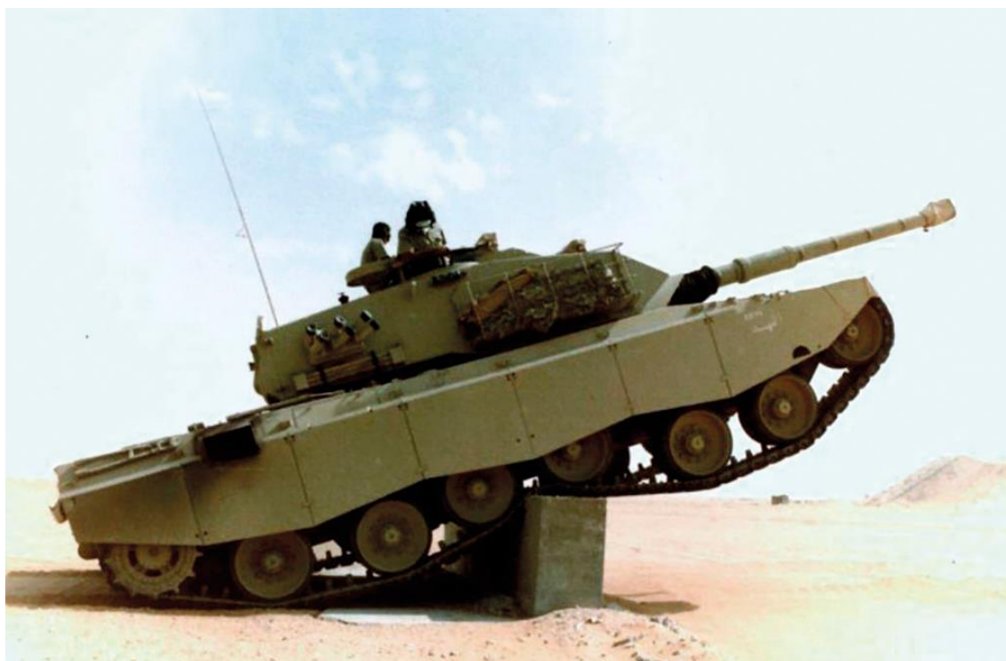
Figura 9 – Potencialidade da suspensão hidropneumática do Osório, quando do teste de desempenho das versões iniciais. Este modelo de suspensão apresentava uma série de vantagens em relação aos tradicionais sistemas de barras de torção. Fonte: ENGESA, via portal Forças de Defesa 546 .
