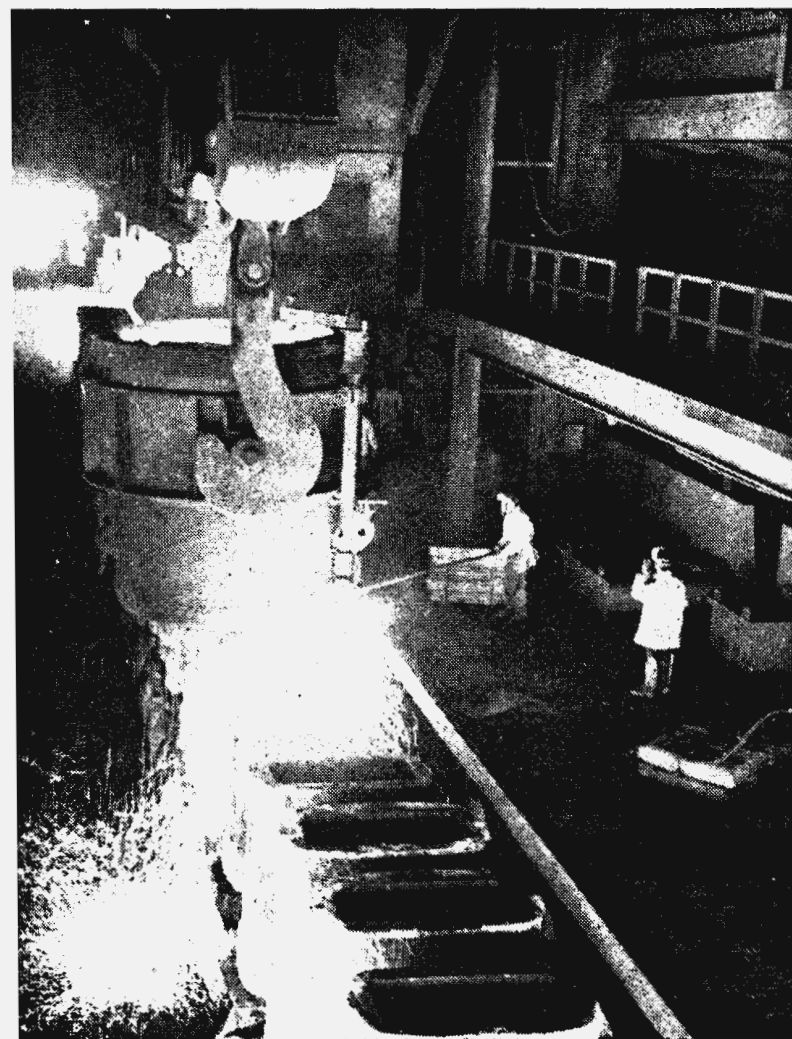
COSIPA: lingotamento de aço na aciaria.
