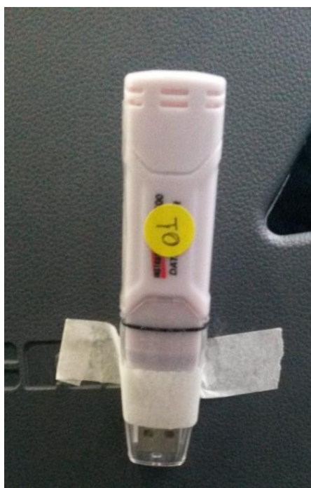
Figura 5- Datalogger digital modelo HT500. Fonte: foto registrada pela autora em 05/05/2019.
