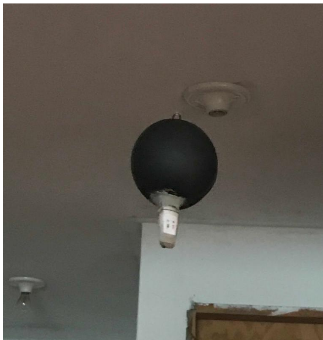
Figura 6- Termômetro de globo negro utilizado nas residências. Fonte: foto registrada pela autora em 18/01/2019.
