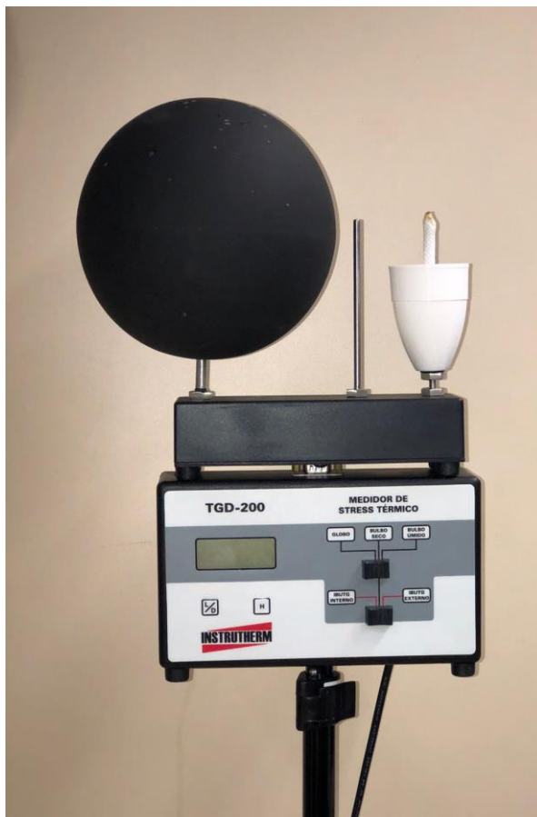
Figura 8- Termômetro de globo negro digital da marca Instrutherm. Fonte: foto registrada pela autora no dia 25/11/2021.
