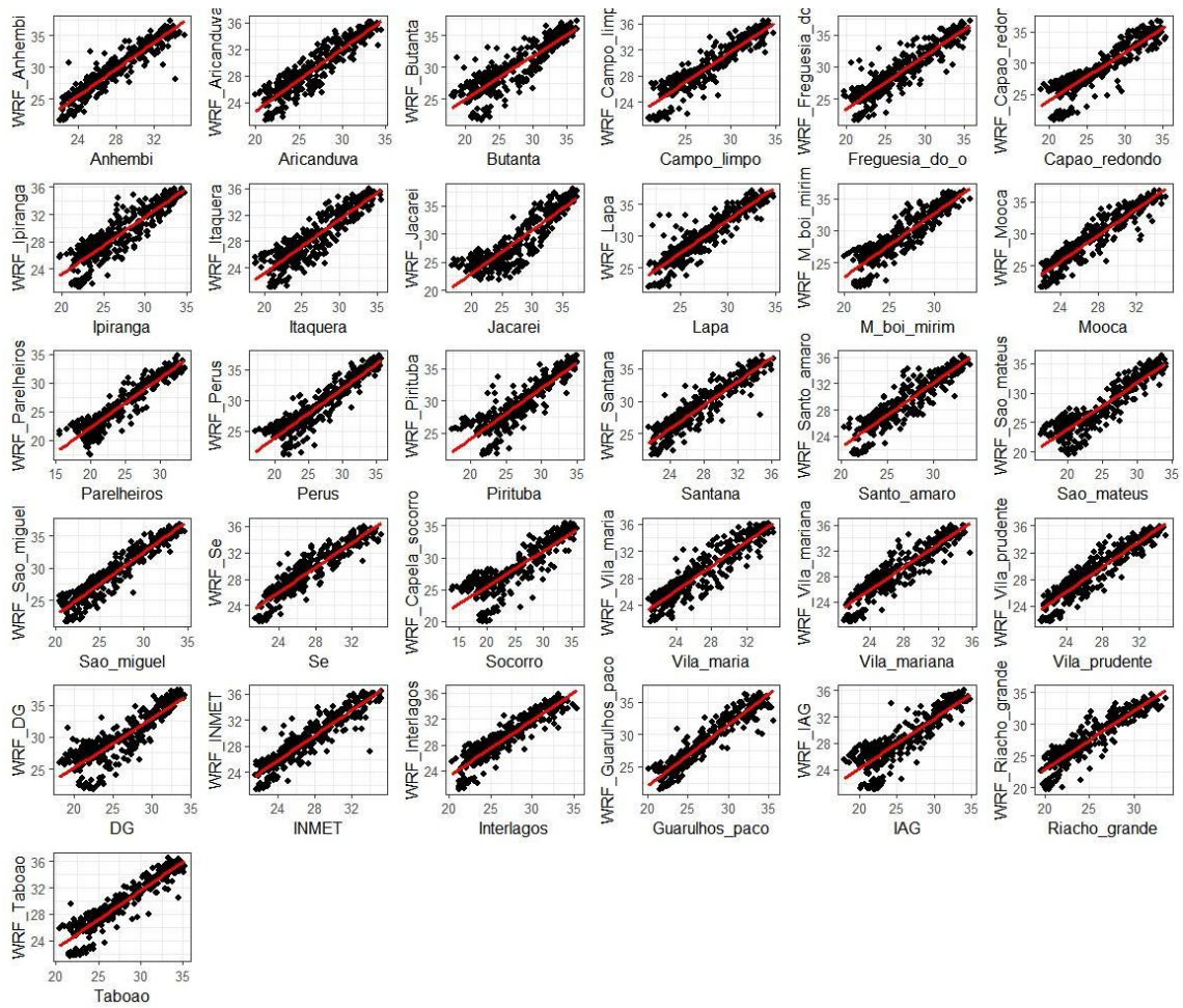
Apêndice 17: Gráficos de dispersão da correlação entre as observações horárias da temperatura do ar das estações meteorológicas e da T2m do modelo WRF no domínio durante o período da onda de calor de 2014.
