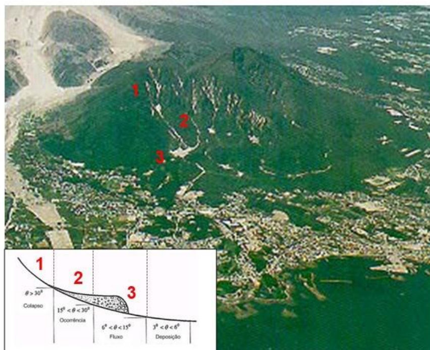
Figura 3: Etapas de movimentação de uma corrida de detritos, onde: (1) corresponde a área de colapso, deflagração das corridas de detritos, (2) área cujo processo predominante é a erosão e (3) fluxo e deposição da massa. Fotografia: Cadeia de montanhas do complexo Monte Unzen no Japão, Japanese Sediment Division, (1991). Perfil: Adaptado de Yi Wu, (2003).
