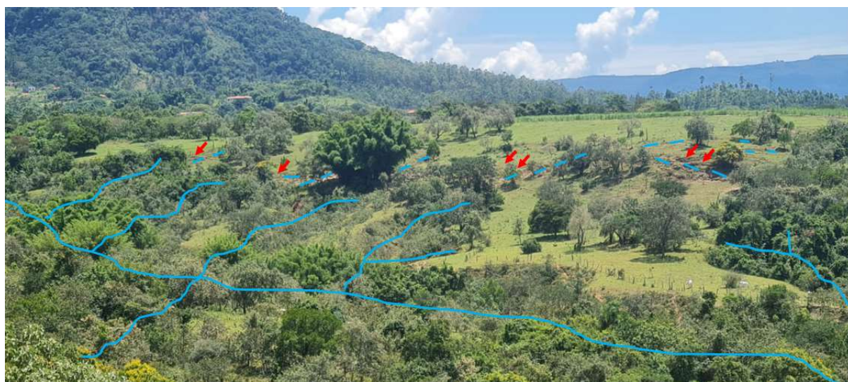
Figura 78: Vista a partir do front de parte da bacia do alto Espraiado. Nota-se as drenagens perenes (linha azul) e também os fluxos superficiais (linhas tracejadas) em que o modelo SIMWE classificou como áreas suscetíveis (seta em vermelho). Figura sem Escala.
