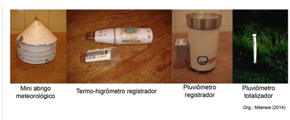
Figura 39 - Equipamento utilizado na montagem das miniestações e postos pluviométricos.
