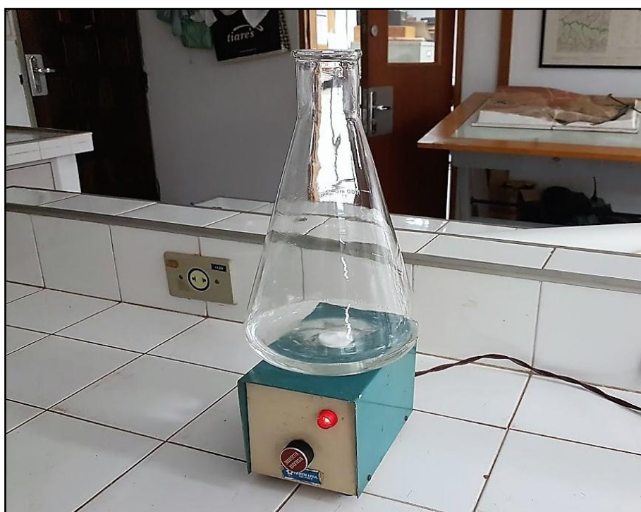
Figura 34: Preparo da solução dispersante com hidróxido de sódio e hexametáfosfato de sódio.
