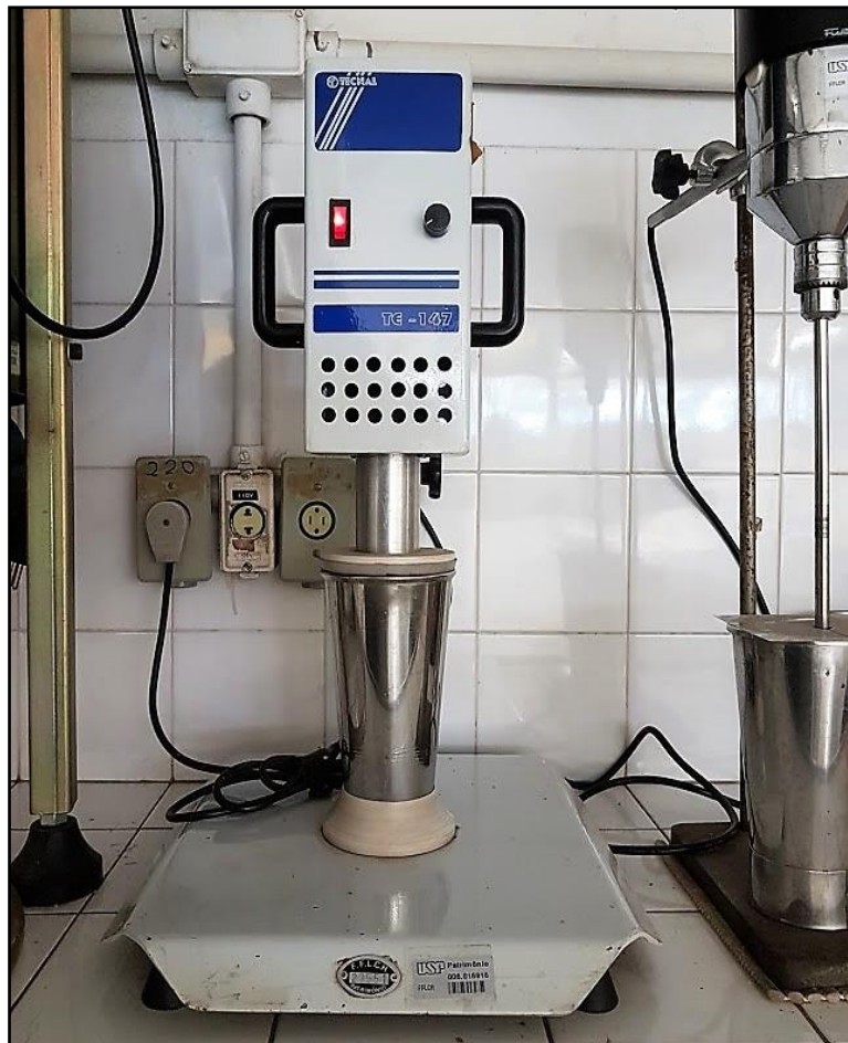
Figura 35: Amostra de TFSA sendo agitada no agitador mecânico.
