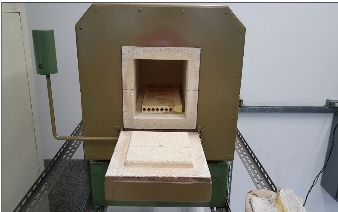
Figura 39: Lâminas impregnadas com argila preparadas para o aquecimento no forno mufla.
