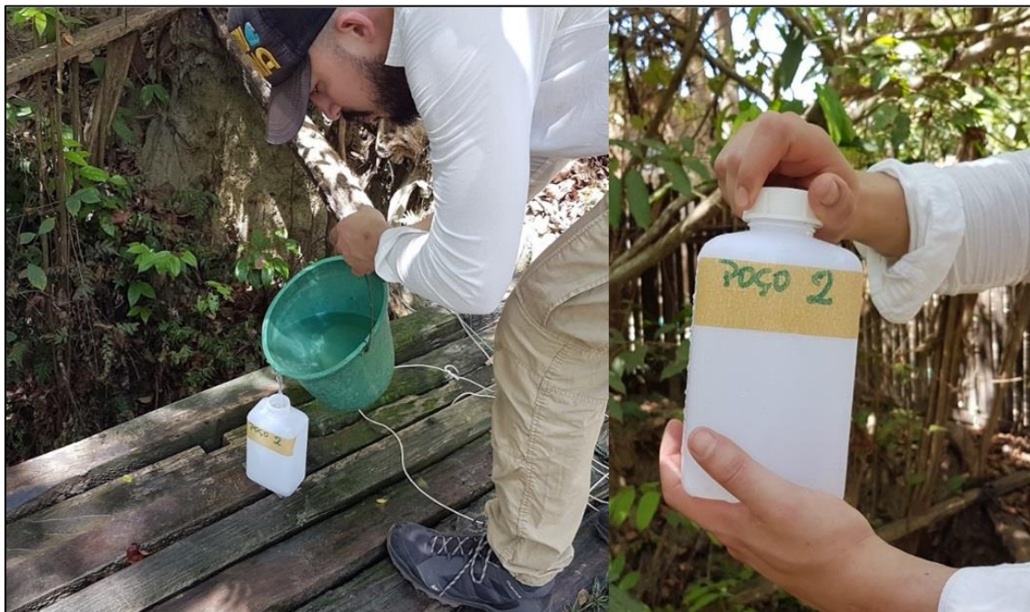
Figura 41: Amostra de água sendo coletada em poço e armazenada em frasco rosqueável de plástico.
