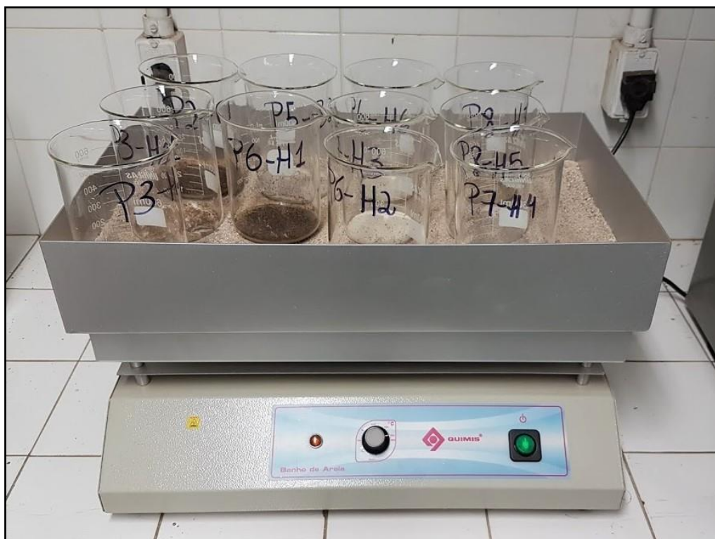
Figura 36: Béqueres com areia secando no banho de areia.
