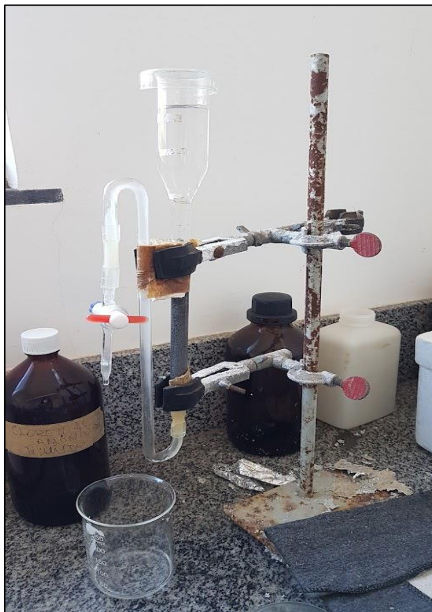
Figura 43: Redução de nitrato a nitrito, água passando por limalhas de cádmio levemente revestidas com cobre metálico.
