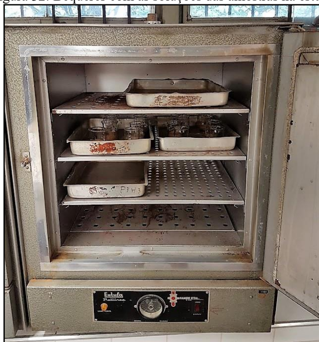
Figura 32: Béqueres com as soluções das amostras na estufa.
