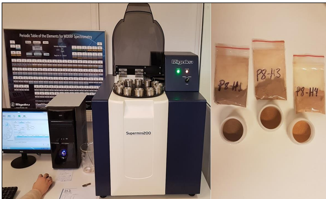
Figura 40: Equipamento de FRX e amostras em pó preparadas para leitura.
