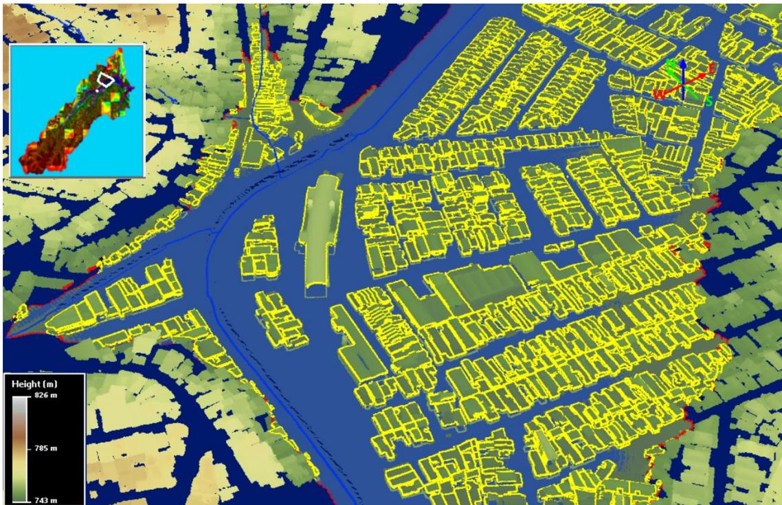
**Figura 15:** Exemplo de extravasamento de 6,5 metros, completo preenchimento da planície fluvial.
