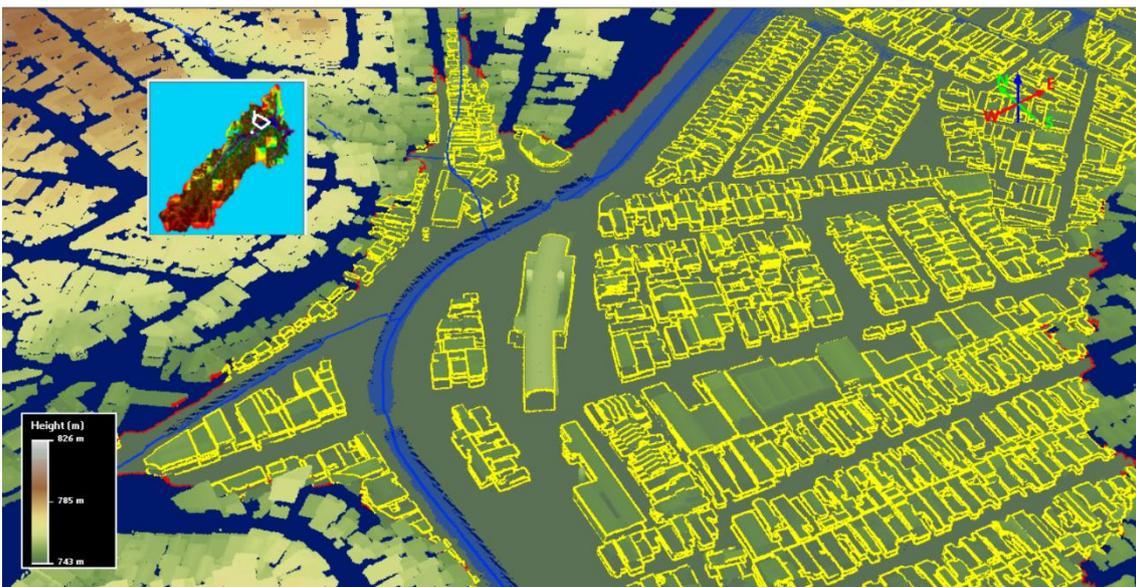
**Figura 14:** Exemplo de preenchimento da PF com extravasamento de 3 metros.
