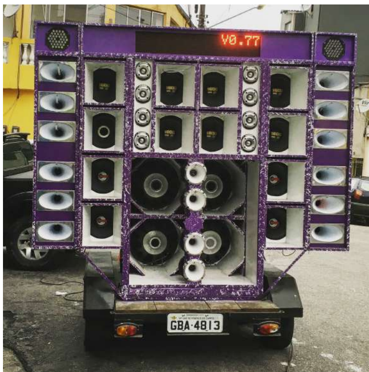
Foto 15: Paredão de som com um total de 40 alto-falantes (entre agudos, médios e graves) estacionado em frente a um bar na Zona Sul de São Paulo, 23 de Março de 2017.
