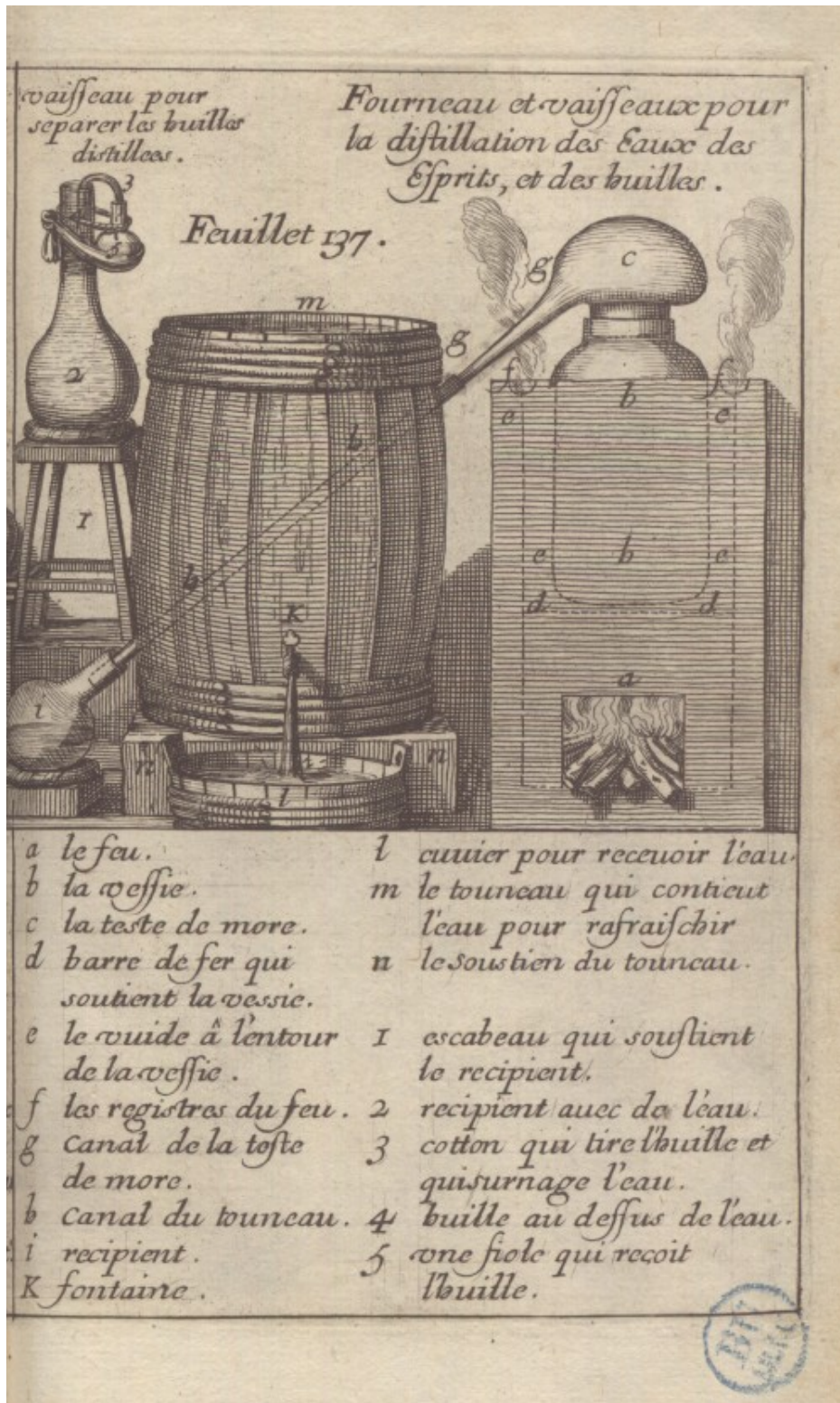
Figura 2: Forno e vasos para destilação de Águas, Espíritos e óleos (LE FEBVRE, 1669)
