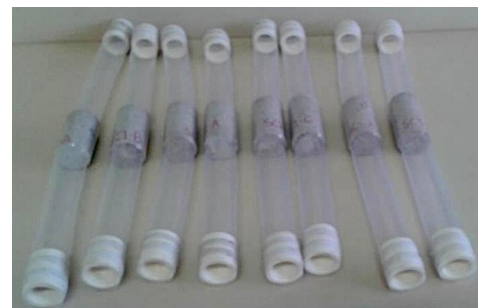
(a) Montagem experimental de bomba HPLC (direita) e sistema de controle de fluxo (esquerda). (b) Amostras de rochas preparadas para experimentos hidrodinâmicos com extensões do material termorretrátil.
