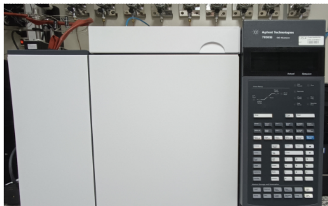
Figura 15 – a) Configuração experimental para as reações de fotocatalise sob simulador solar b) Cromatógrafo de gases Agilent 7890B.
