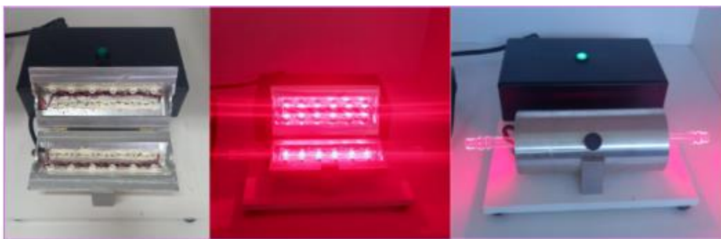
Figura 21 - Imagem ilustrativa da fonte de irradiação (660nm) utilizada para a inativação fotodinâmica de S. aureus em meio circulante.
