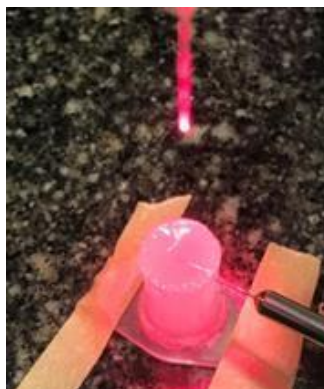
Figura 9 - Phantom sendo irradiado com a agulha térmica acoplada.
