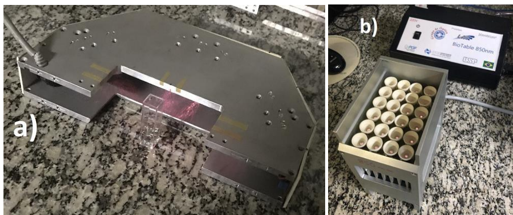
Figura 8 – Equipamentos de iluminação utilizados, sendo em a) a lasertable de 808 nm irradiando uma amostra e em b) uma biotable de 850 nm com seus LEDs.
