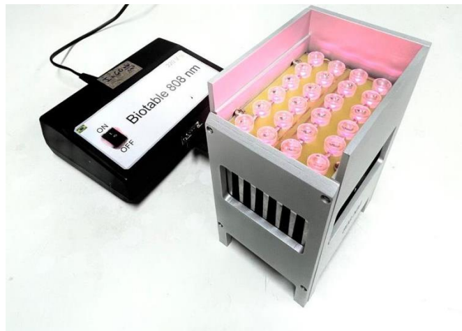
Figura 5 – Biotable de 808 nm utilizada para iluminação.
