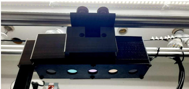
Figura 20 – Módulo contendo as quatro câmeras espectrais e a câmera RGB instalados no sistema de trilhos.
