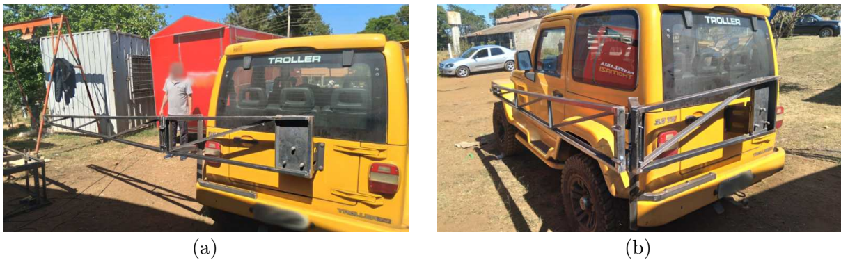
Figura 57 – Barra de pulverização em menor escala desenvolvida para instalação em veículo automotor visando a construção de novos bancos de imagens multispectrais em campo e validação do sistema. a) Barra aberta; b) Barra fechada.
