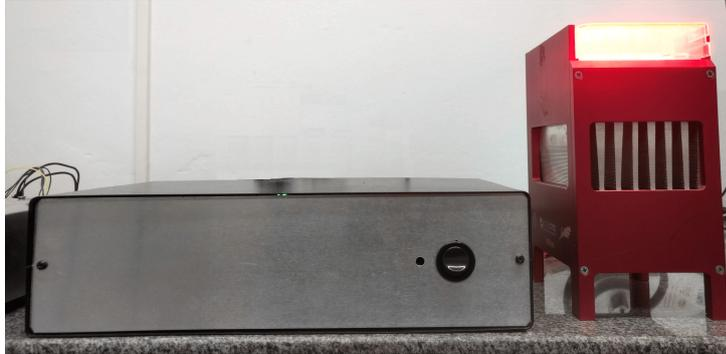
Figura 5.4 – Equipamento *biotable* com placa de 24 poços e fonte de energia construída.
