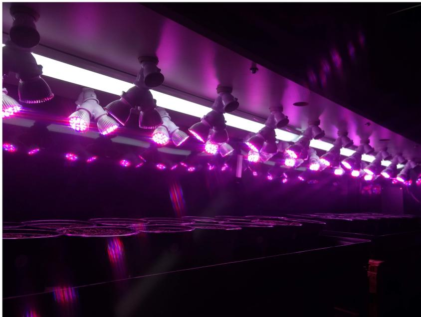
Figura 5.13 – Bancada de cultivo de plantas de soja construída com iluminação artificial.
