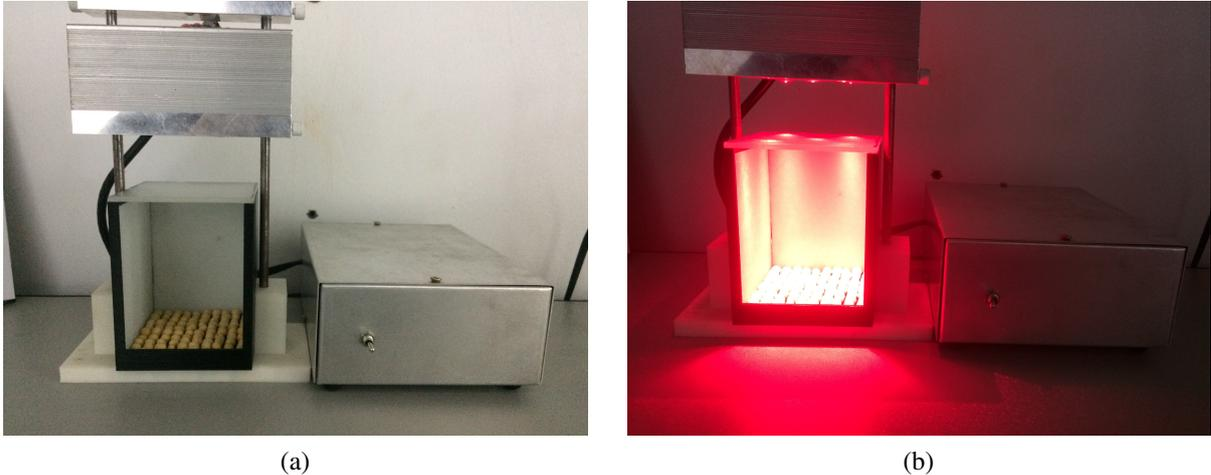
Figura 5.9 – Equipamento desenvolvido contendo cinco *lasers* de diodo de comprimento de onda 660 nm conectado à fonte de energia desenvolvida. (a) Estrutura do equipamento com 100 sementes de soja no porta-amostras. (b) Equipamento ligado.
