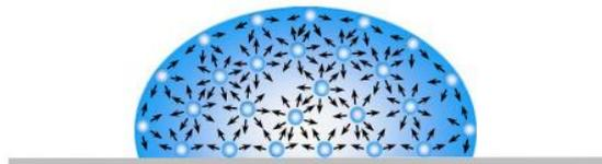
Figura 9 - Representação da ação das moléculas que causam a tensão superficial em uma superfície.
