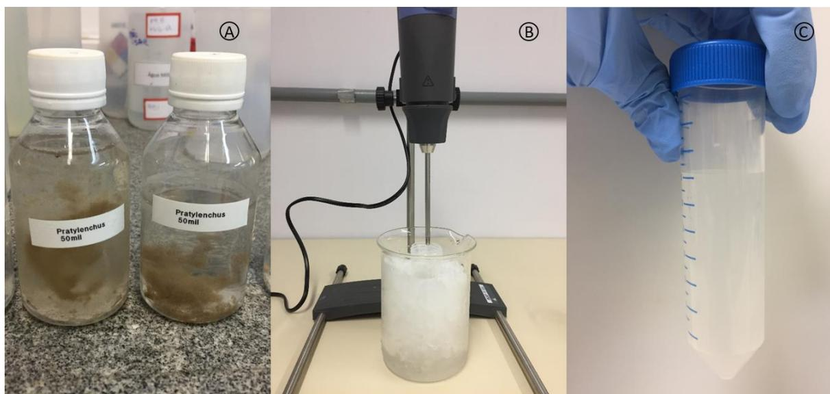
**Figura 4.3** – Extração de proteínas de nematoides: Amostras coletadas em solo antes da remoção de resíduos (A), processamento em turrax (B) e homogenato contendo as proteínas (C).
