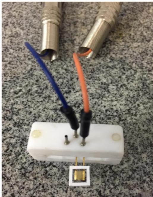
**Figura 4.5** – Montagem do sistema para medidas elétricas: Eletrodo interdigitado, com área delimitada por adesivo isolante, é inserido em um suporte de três contatos conectados por dois cabos ao espectrômetro.
