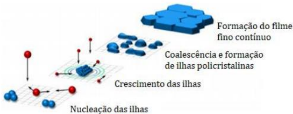
Figura 20 - Mecanismo de crescimento de filmes finos sobre substratos planos.
