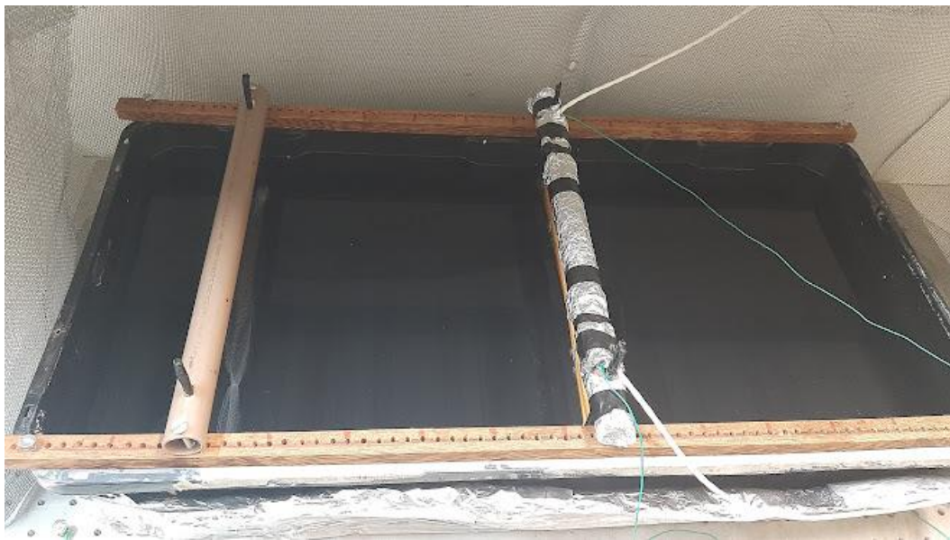
Figura 7 - Foto do tanque utilizado nos experimentos. Adaptamos dois trilhos de madeira para ajustar a distância d entre a fonte emissora de sinal (esquerda) e a sonda (direita), mantendo seu paralelismo e profundidade. Desse modo podemos ajustar o valor de d em passos de 1 cm. Abaixo do suporte de PVC, do lado esquerdo, podemos ver um peixe transmissor submerso, mantido em uma posição fixa usando uma malha de tule. Os fios verdes que saem da sonda, à direita, são para aterramento da blindagem. Os cabos brancos são as conexões dos sensores CH1 e CH2 aos amplificadores diferenciais.
