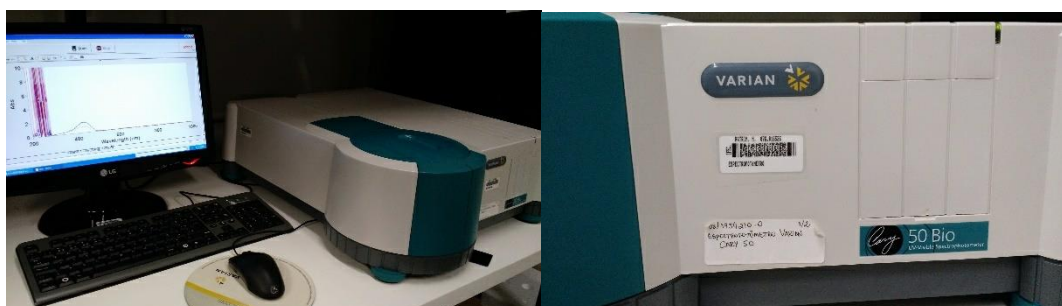
Figura 7 - Cary UV-Vis 50 – Varian. Fonte: Elaborada pelo autor
