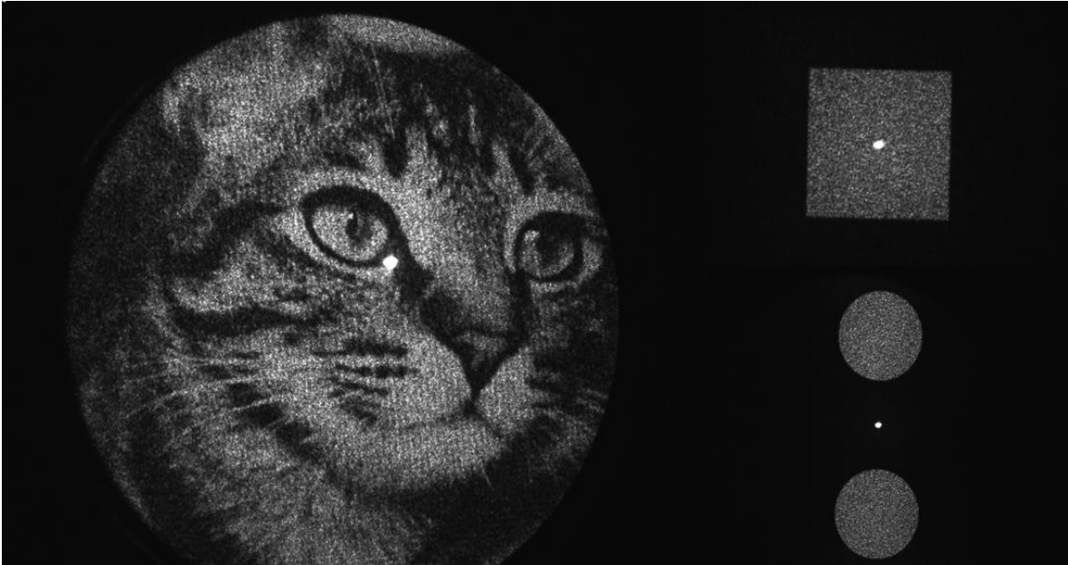
Figura 3 - Potenciais Ópticos gerados em laboratório a partir do algoritmo GS. Os potenciais foram gerados a partir de um LC-SLM, uma lente convergente e uma câmera CCD.
