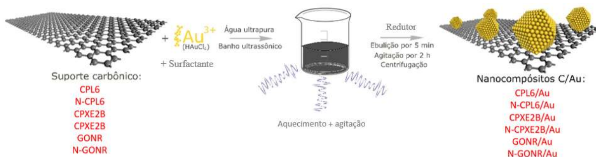
Figura 3 - Representação esquemática do método de síntese dos nanocompósitos C/Au.
