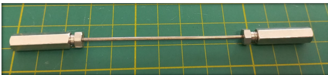
Figura 10. Fotografia de uma das colunas capilares produzidas, essa empacotada com partículas de 3 \mu\text{m} de diâmetro. Fonte: Autoria própria.
