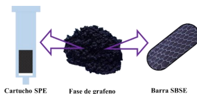
Figura 3. Representação de dispositivos de preparo de amostras produzidos com derivados de grafeno. Fonte: Autoria própria.
