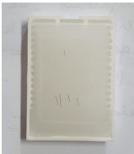
Figura 18. Cabelo fixado em parafina após tentativa de corte no micrótomo. Fonte: Autoria própria.
