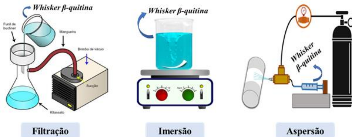
Figura 7 - Métodos estudados para modificação da superfície dos nãotecidos com whisker de \beta -quitina, a saber: filtração, imersão e aspersão.
