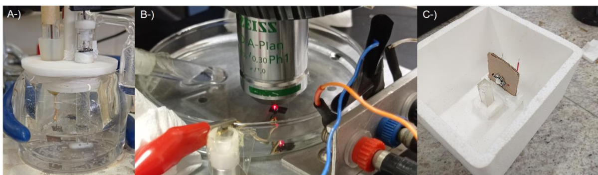
Figura 6 - Célula eletroquímica (a) encamisada empregada na deposição do Se e dos metais (b) utilizada nas medidas espectroeletroquímicas (c) cubeta de quartzo para as medidas fotoeletroquímicas.
