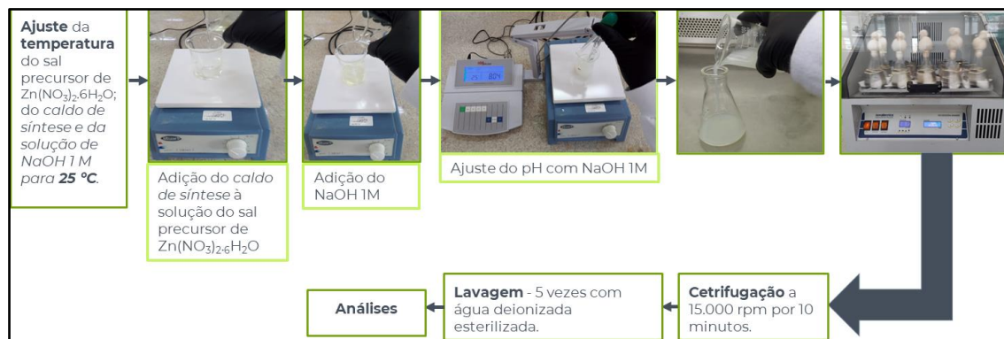
Figura 27- O esquema de montagem usado nas Sínteses 4-8 .
