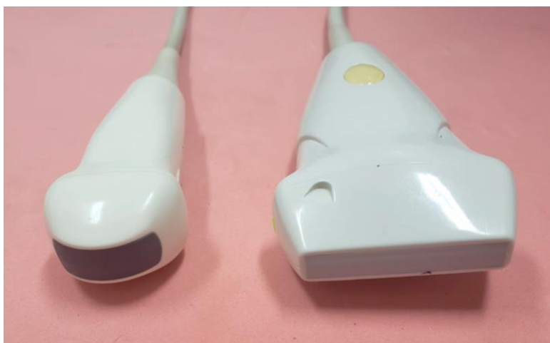
Figura 10. Transdutores microconvexo (à direita) e linear (à esquerda) utilizados para a execução do exame ultrassonográfico.
