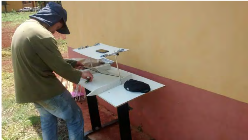
Figura 23 - Mesa de captação com quebra vento
