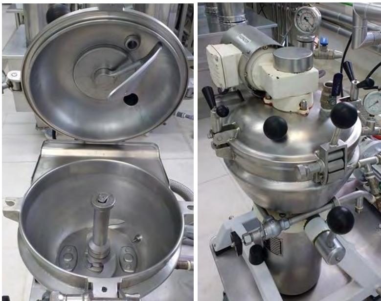
Figura 9: Tacho de cozimento Geiger modelo UMMSK-12E.
