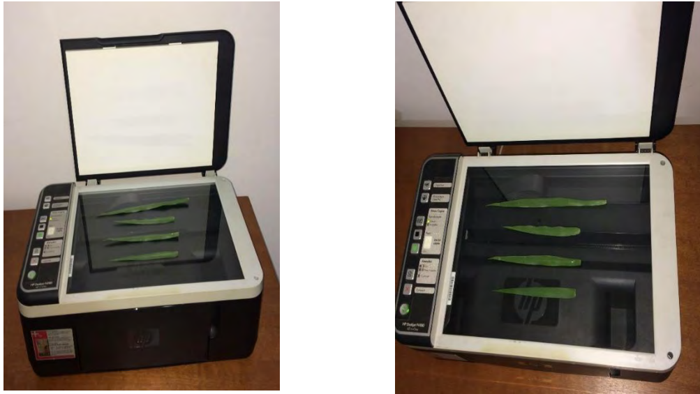
Figura 26 - Disposição da lâmina foliar da planta, objeto de interesse, através de scanner de mesa para aquisição de imagens. Neste caso, a face adaxial da lâmina foliar deve permanecer voltada para baixo.
