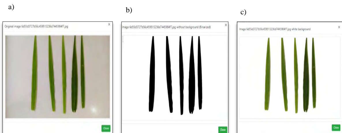
Figura 38 - Imagem original que foi submetida ao software (a), imagem binária com objeto de interesse destacado em relação ao seu background (b), imagem original com background removido (c).
