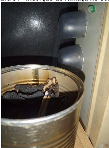
Figura 34 - Inserção de fumaça no sensor
