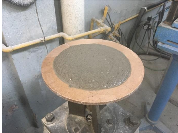
Figura 12 - Medida da fluidez da argamassa
