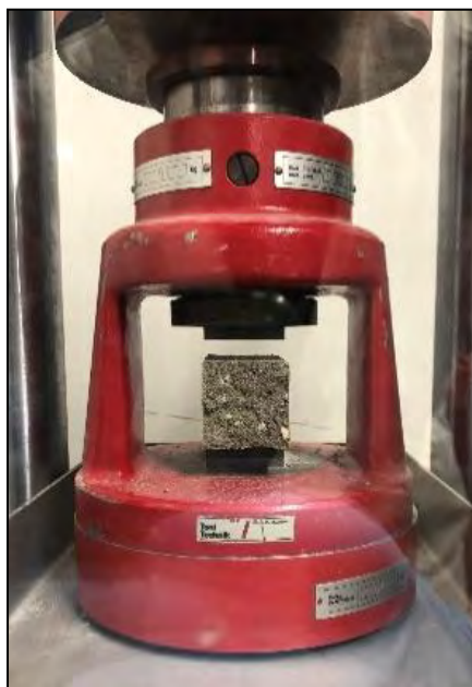
Figura 35 Dispositivo de carga para determinação da resistência à compressão em argamassas.
