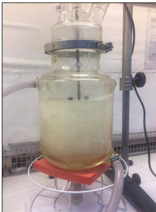
Figura 21 Reator de vidro encamisado com carbonato de propilenos, pré-polímeros e fibras de celulose.
