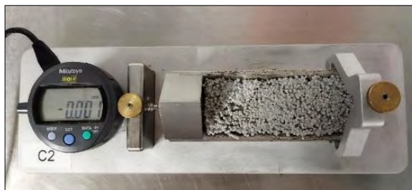
Figura 37 Ensaio de retração realizado durante o período de cura das argamassas.
