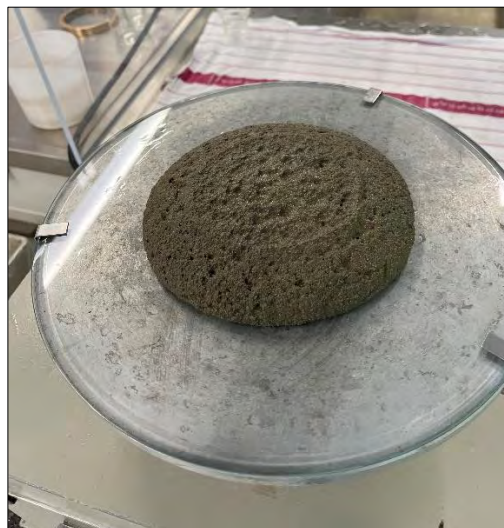
Figura 32 Determinação do índice de consistência das argamassas cimentícias na mesa de fluxo.
