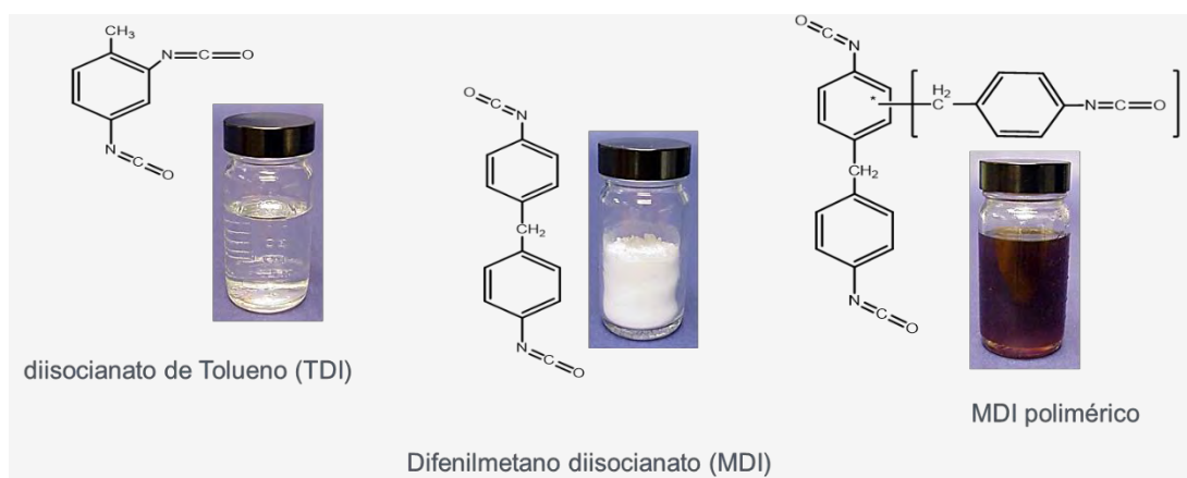
Figura 13 Estrutura química do diisocianato de tolueno (TDI), difenilmetano diisocianato (MDI) e MDI polimérico.
