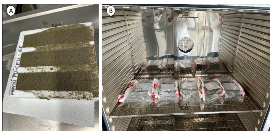
Figura 33 A. Corpos de prova durante 48 h após o preparo. B. Corpos de prova durante a cura térmica.
