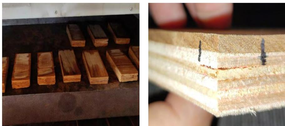
Figura 16 - Ensaio de Delaminação em água fria. (a) Secagem em estufa. (b) CP no momento da aferição das delaminações.
