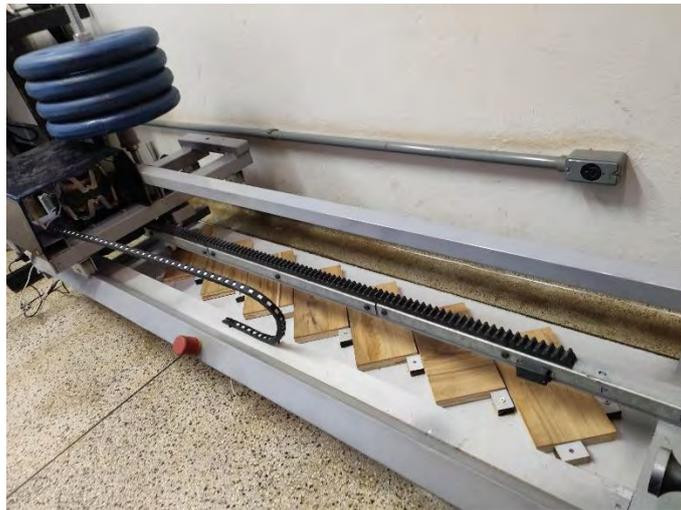
Figura 17 - Ensaio de Resistência ao Esforço Rolante.
