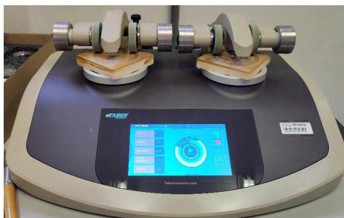
Figura 19 – Ensaio de Abrasão.
