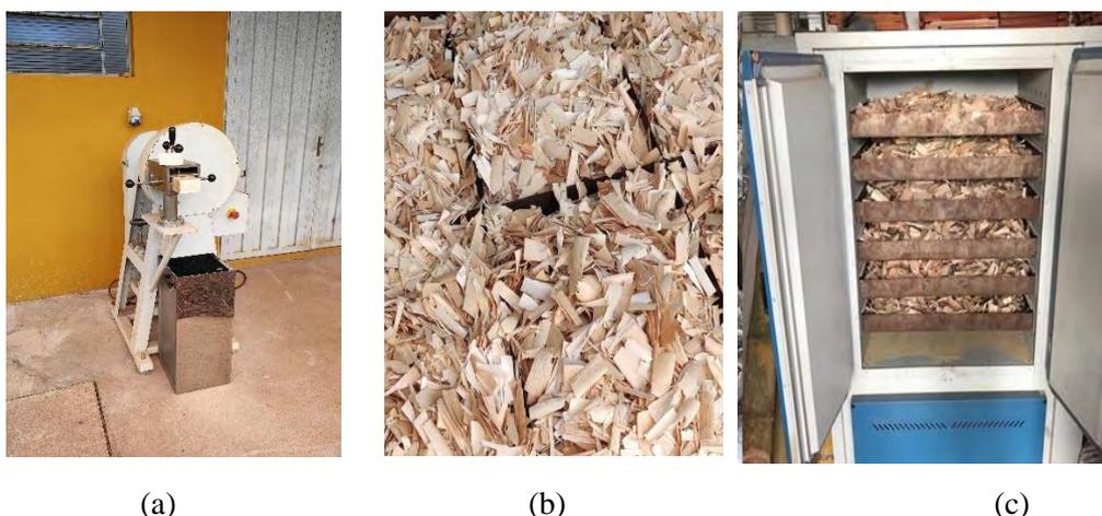
Figura 12 - Processo de obtenção de *strands* de madeira Balsa. (a) Moinho de discos. (b) Preparação das lascas para serem inseridas na estufa. (c) Estufa utilizada para o processo de secagem.
