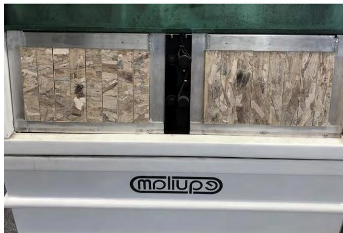
Figura 14 - Amostras de painel OSB de madeira Balsa residual de reflorestamento em câmara de intemperismo artificial
