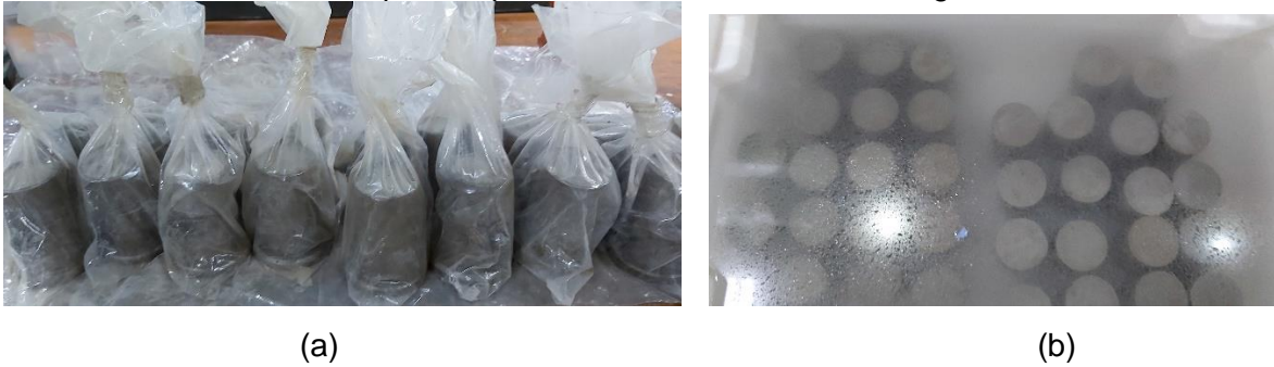
Figura 16 – Ilustração das argamassas (a) moldes de argamassas para saturação e (b) corpos-de-prova colocas submersos em água
