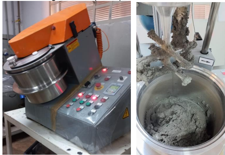
Figura 14 – Ilustração da preparação da argamassa (a) misturador em utilização, (b) massa da argamassa após o processo de mistura
