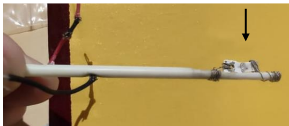
Figura 7.3. Porta amostras de alumina e amostra em barra retangular com fios de platina (eletrodos) enrolados em suas bordas após a sinterização.
