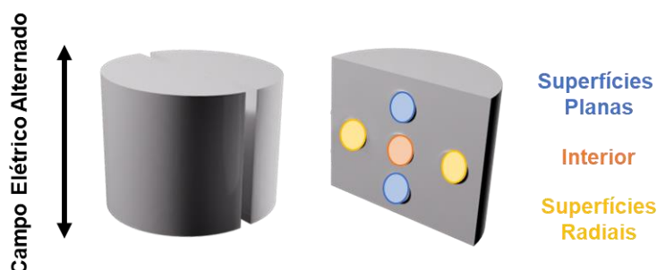
Figura 2.1. Seção longitudinal radial de uma amostra cilíndrica e sua superfície polida, com destaque para as regiões em que a microestrutura foi analisada.
