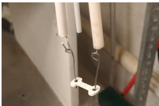
Figura 5.2. Amostra dog-bone pendurada por dois fios de platina.
