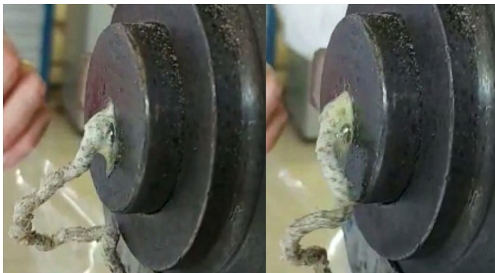
Figura 14. Extrusora expelindo lipídios ao extrusar a formulação com torta de girassol Fonte: Elaboração própria
