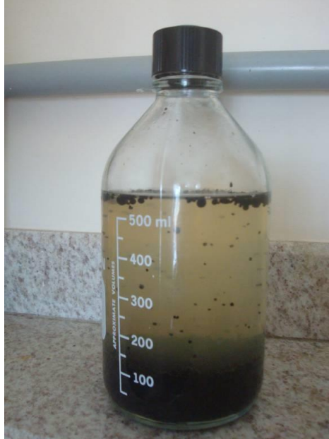
Figura 9: Frasco Fermentador com lodo anaeróbio e solução de sacarose.
