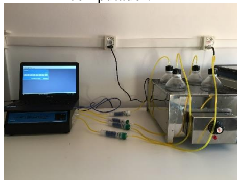
Figura 10: Frascos fermentadores em banho maria, conectados ao respirômetro, ligado ao computador.
