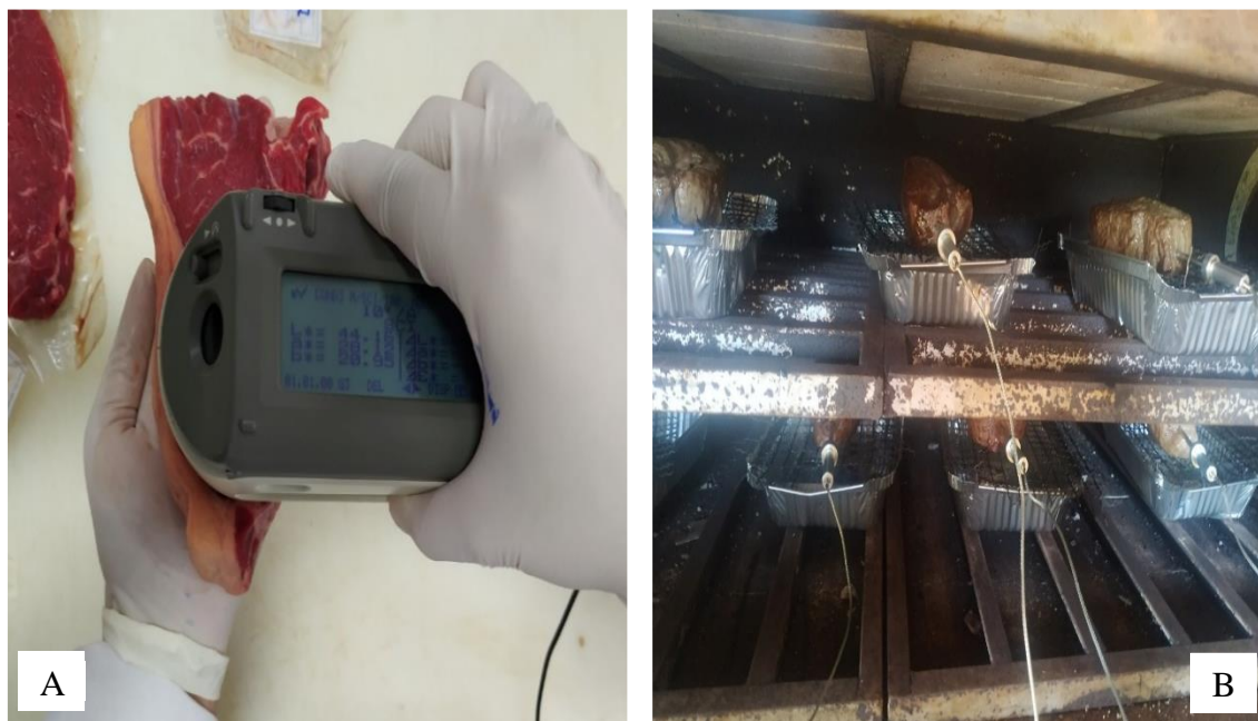
Figura - 3. A: análise da cor com espectrofotômetro para medições dos valores L^* a^* e b^* ; B: amostras dentro do forno monitoradas com termômetros até atingir a temperatura definida. Fonte: própria autoria.
