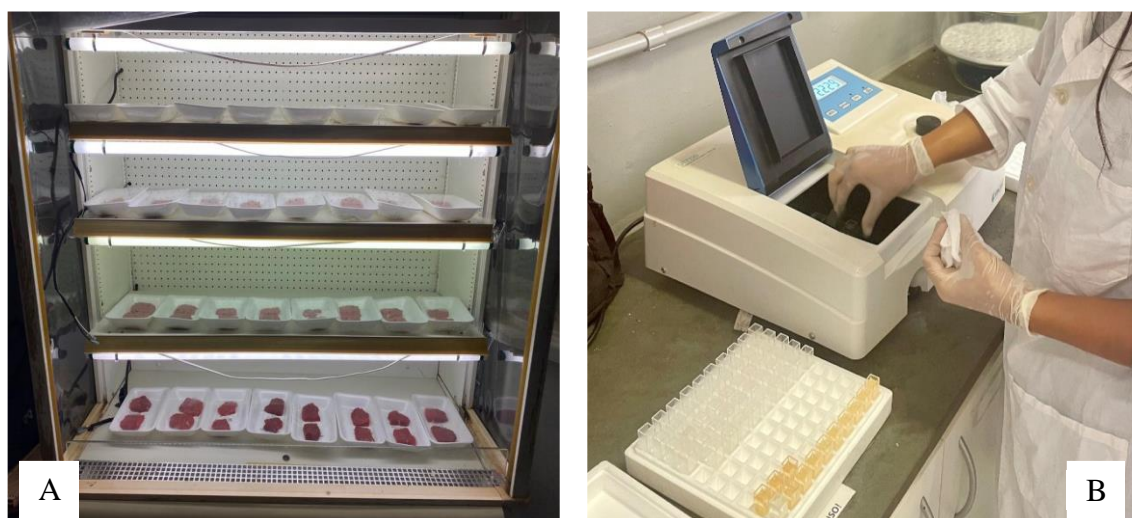
Figura - 6. A: vida útil, simulação do produto no varejo; B: oxidação lipídica, leitura das absorbâncias das amostras no espectrofotômetro.
