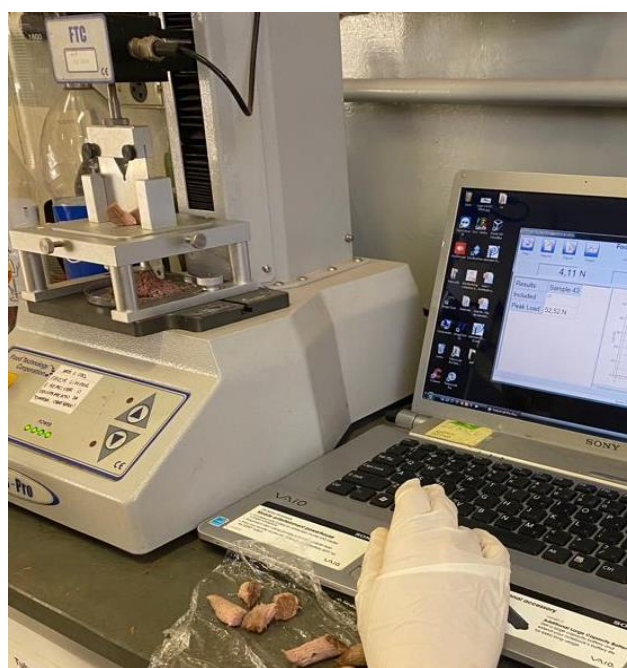
Figura - 4. Avaliação da força de cisalhamento por meio de texturômetro. Fonte: própria autoria.
