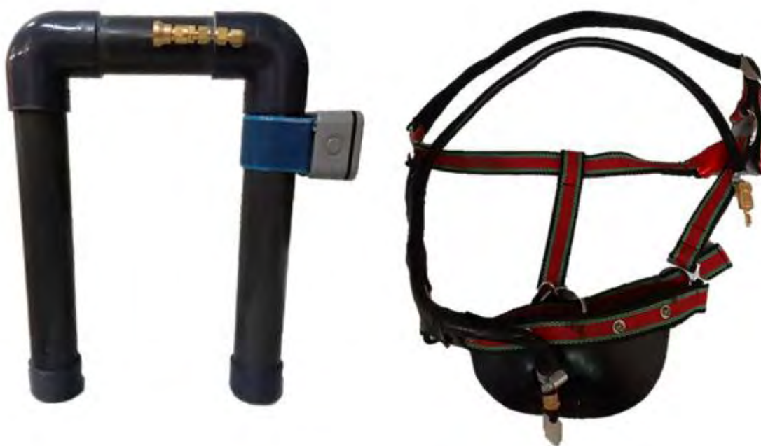
Figura 26 – Canga e cabresto montados para a coleta de CH 4 segundo a metodologia do gás traçador SF 6 .
