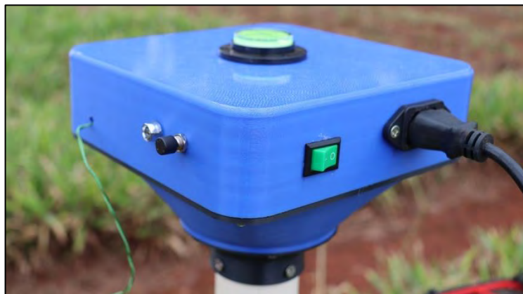
Figura 55 - Instalação de conector para alimentação através da placa solar
