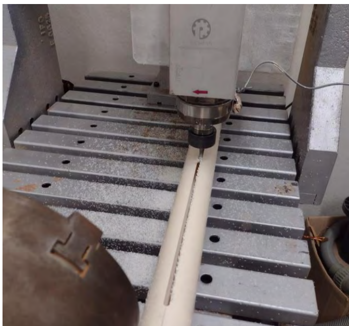
Figura 27 - Corte tubo PVC utilizando fresadora.
