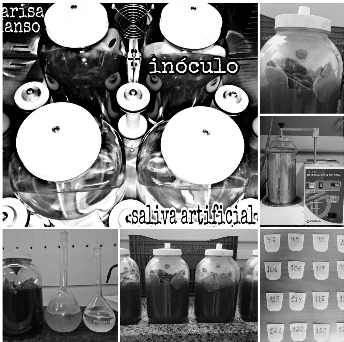
Figura 9 – Jarros em digestora (os dois superiores com inóculo e os dois inferiores apenas com solução tampão – saliva artificial), detalhe da válvula de escape de gases na tampa do jarro. Solução de Pepsina e Ácido Clorídrico, jarros com amostras e amostras antes da digestão. Fonte: Própria autoria.
