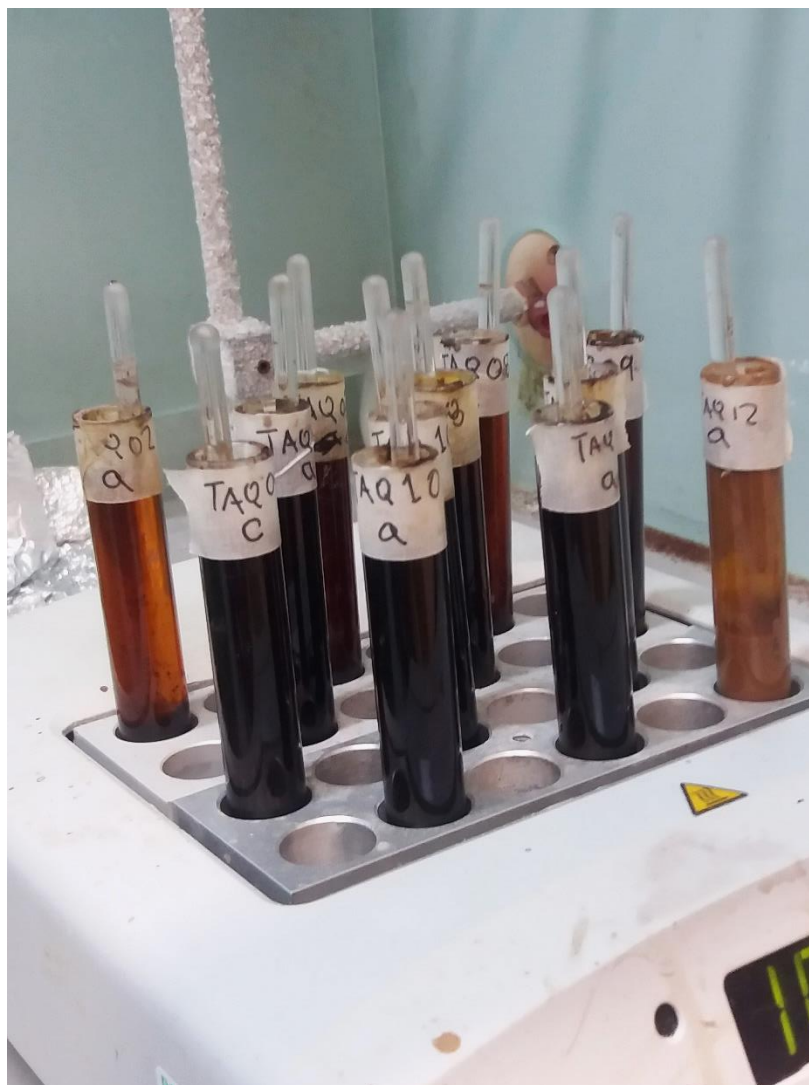
Figura 20 Amostras com ácido nítrico (HNO 3 ) sendo aquecidas
