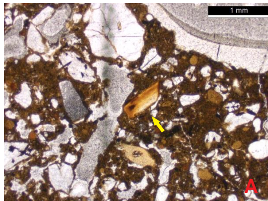
Figura 37: Fotomicrografias da lâmina TPM-P1-A5: (A) Osso queimado – PPL (seta amarela). (B) Agregado de argila com espículas de esponjas e quartzo – PPL (seta amarela). (C) Grãos de quartzo observados sob XPL confirmando os resultados da granulometria acerca da presença de material na fração silte e sortimento moderado.
